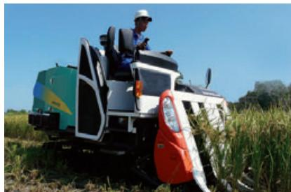
細断型ホールクローブ収穫機
