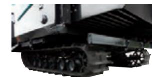
低接地圧で機体バランスが良く、軟弱地でも安定して作業が行えます。
