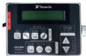
ネット・トワインの巻き付けから、チャンバ開閉までの一連の動作を全自動で行えます。
