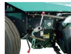
カッティングドラムの底板とナイフ(CRのみ)を手動レバーで下ろすことで、草詰まりの除去ができ作業復帰が簡単に行えます。
