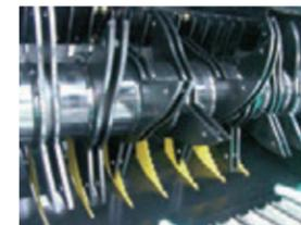
パワーカットロールベアラは、収穫作物を理論切断長9cmにカット。高密度梱包で高品質なサイレージづくりに最適で、給餌も楽に行えます。
