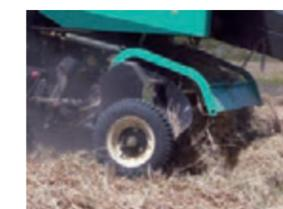
ピックアップゲージホイールを標準装備。地面の凹凸に対応して泥の掻き込みを抑制します。ピックアップの昇降は電動式で運転席から行えます。
