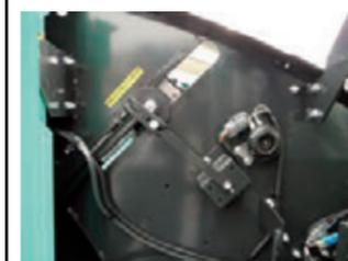
タイトチェーンの圧力を感知するポテンショメータを採用。ベール直径がΦ100cmで安定して成形されます。
