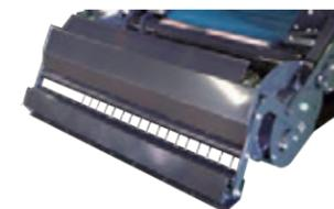
作業幅145cmのワイドピックアップ。ローラ機構を装備し、成形室へのワラの送り込みがスムーズに行えます。運転席からの高さ調整が行えます。
