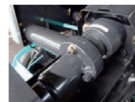
入力軸にシェアボルトを設け、過負荷による機械の破損を防止します。
