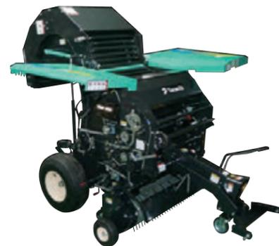
機体両側のカバーは上下に開閉し、メンテナンス作業がしやすいガルウイング方式を採用。
