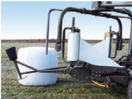
フィルムの重なりが多い底面を地面に降ろせるのでフィルム破れを抑制でき、ベールグラブ等での後工程もスムーズに行えます。
