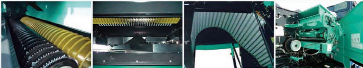
①ディスクカッタ 理論切断長3cmに作物をカット ②ダブルディスク 穂先と株元を混合 ③チェン/バー方式 高密度に圧縮 ④ネット装置 ロスを少なく 速やかに結束
