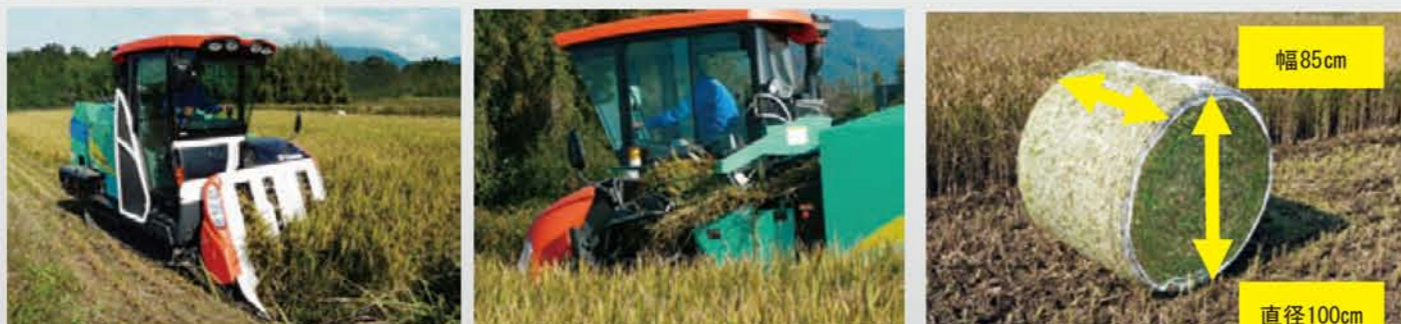
①長稈品種対応 飼料イネの特徴である長稈品種もの草丈150cmまで対応できます。 ②短稈対応 短稈でも刈取部から搬送部への受渡しがスムーズです。
